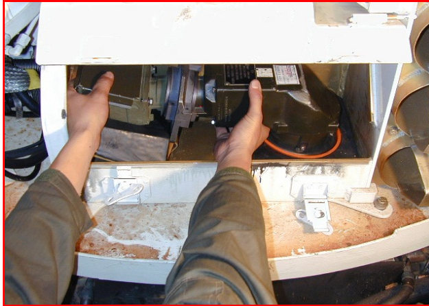
附圖十 AN/VVS-2 星光夜視鏡安裝實體圖(三)
