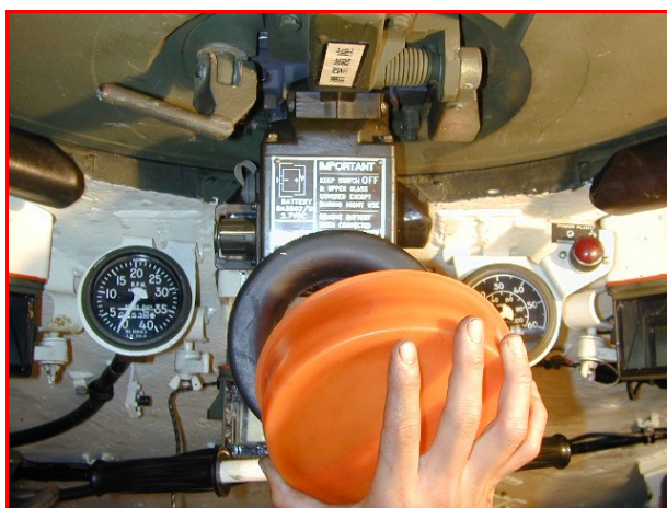
附圖十八 AN/VVS-2 星光夜視鏡安裝實體圖(七)
