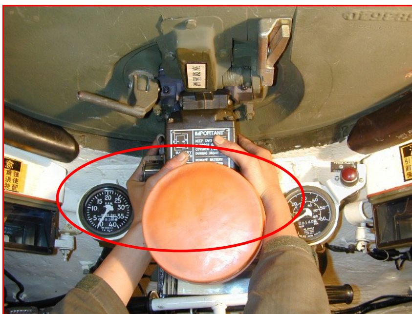
附圖十三 AN/VVS-2 星光夜視鏡安裝實體圖(四)
