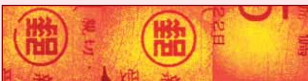
圖九：號碼牌分別放入塗抹1,2-茛二酮試劑1次、5次、10次的A4紙中（由左至右），反應10天後，在530nm光源照射下，透過橘紅濾鏡觀察檢體螢光顯現的情形。
