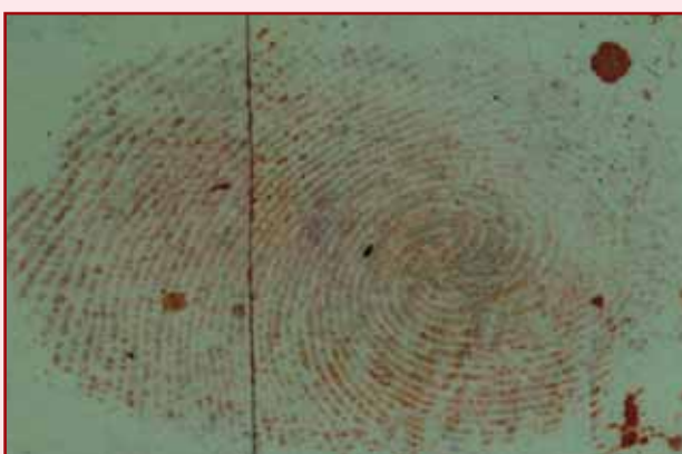
圖十：ATM收據正面（右半部：浸泡丙酮5分鐘；左半部：浸泡丙酮30分鐘）。
