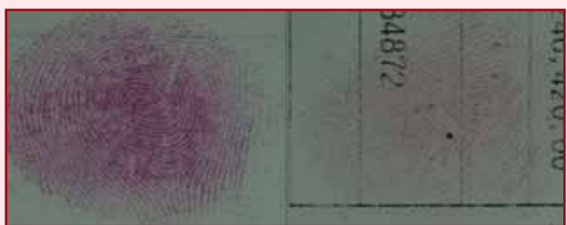
圖四：調整寧海德林溶劑中的甲醇含量後，再對郵局ATM收據作指紋顯影的效果。
