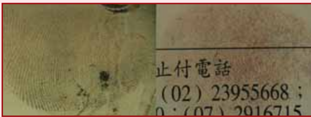
圖一：碘燻法對第一銀行（左）與郵局（右）ATM交易憑單的指紋顯現效果。
