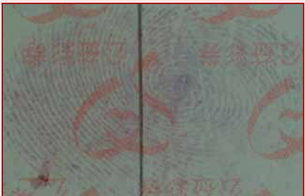
圖十一：彩券正面（右半部：浸泡丙酮5分鐘；左半部：浸泡丙酮30分鐘）。
