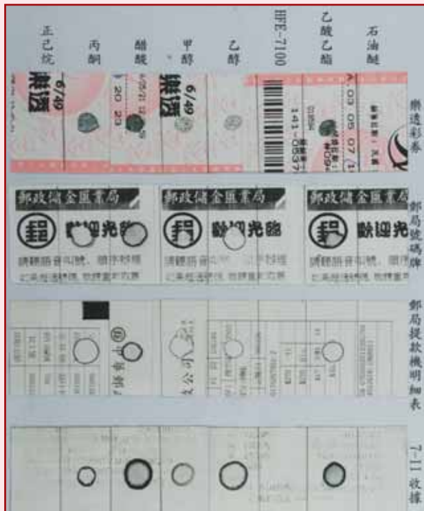
圖七：由右至左分別使用石油醚、乙酸乙酯、HFE-7100、乙醇、甲醇、醋酸、丙酮、正己烷等有機溶劑，分別滴在樂透彩券、號碼牌、ATM收據及7-11收據上，經觀察可發現除石油醚、HFE-7100及正己烷不會對熱感紙造成任何影響之外，其餘溶劑都會使熱感紙變黑或褪色。
