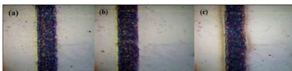
圖 10. 不同移動平台速度刻劃試片結果圖（光學影像），刻劃速度：(a)0.313 mm/s；(b)1.563 mm/s；(c)3.125 mm/s。
