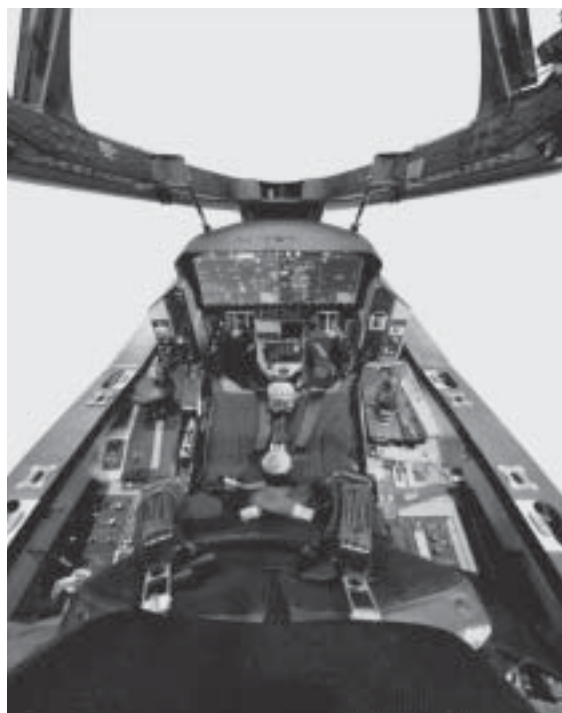
F-35戰機座艙及多功能彩色液晶顯示幕
