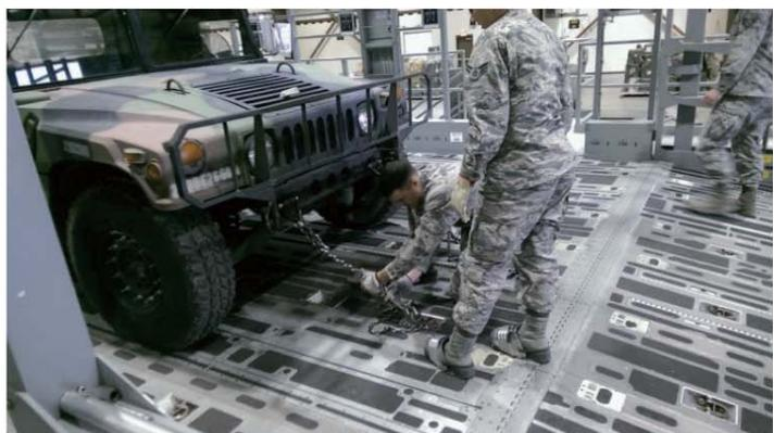
圖二 空運補給作業，C-130裝載訓練模擬艙 (資料來源：作者拍攝)
