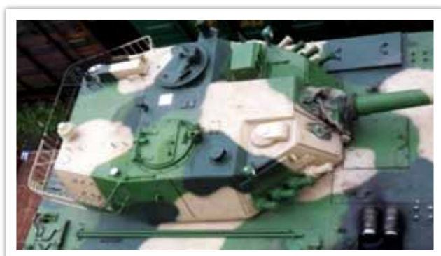
圖二 兩棲突擊砲車煙幕彈發射器
