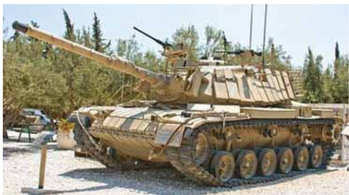
圖十 馬戈奇6B主戰車，明顯可見M60戰車原貌，車體表面外掛反應裝甲
