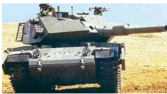
圖十二 以色列薩布拉MK-1主戰車原型車，此角度能清楚觀察薩布拉原型車的新式砲手瞄準儀及煙幕彈發射器
