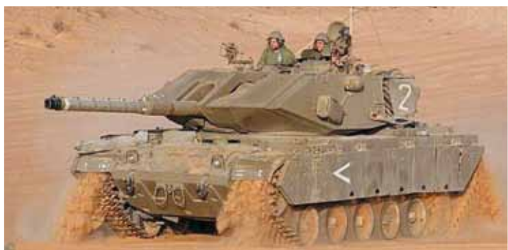
圖十一 馬戈奇7C主戰車，砲塔及車側加裝被動裝甲套件，構型明顯有別於馬戈奇6B
