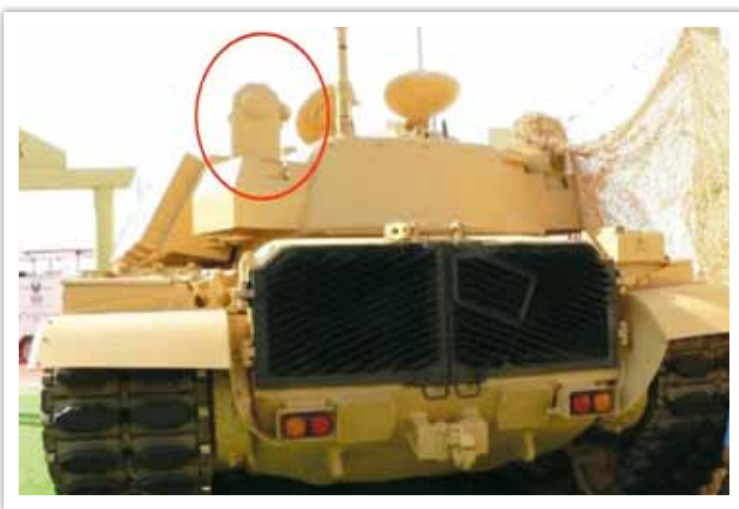
圖九 約旦M60鳳凰主戰車車尾榴彈發射器
