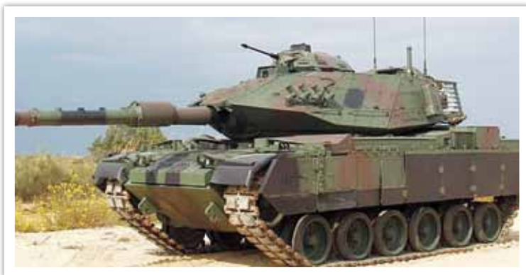
圖十三 土耳其陸軍的M-60T(薩布拉MK-2)主戰車與圖十二的薩布拉MK-1相較，MK-2保留原本M-60的車長旋轉槍塔
