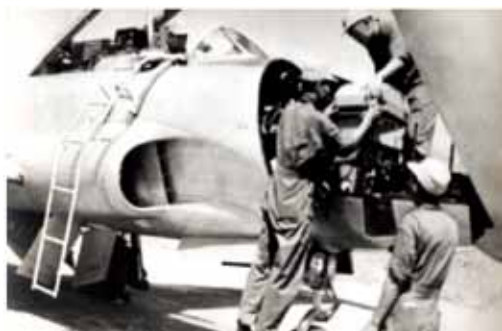
圖2-21 RT-33A偵察機裝掛相機作業 資料來源：第十二戰術偵察機隊提供
