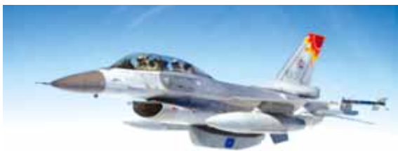
圖2-37 攜掛偵照莢艙的RF-16型機 資料來源：第十二戰術偵察機隊提供
