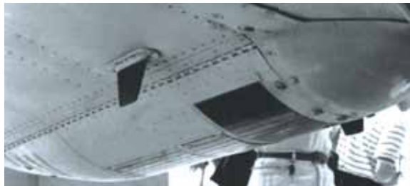
圖2-29 位於機腹下方裝置相機的淚滴型英艙 資料來源：傅鏡平先生提供
